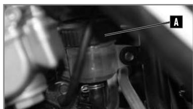
El depósito del líquido del freno trasero se encuentra junto a la palanca de arranque mecánico.
