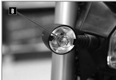
Type d'ampoule: 12V R10W
