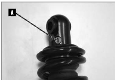
Le réglage en détente de l'amortisseur s'effectue à l'aide de la vis de réglage **A** situé sur la partie supérieure de l'amortisseur.
