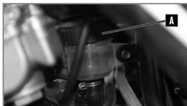
Der Bremsflüssigkeitsbehälter der Hinterradbremse befindet sich neben dem Kickstarter.
