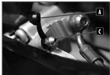
Zum Entlüften der Bremsflüssigkeit der Hinterradbremse:
