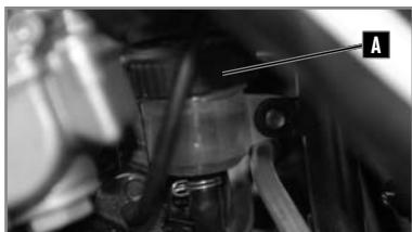
Le réservoir du liquide de frein arrière est situé à côté du levier de démarrage mécanique.
