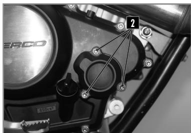
Den auf der rechten Seite des Motorrads befindlichen Deckel des Ölfilters abnehmen, nachdem seine 3 Schrauben **2** entfernt wurden.
