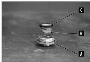
Retire el tapón de vaciado **A** y el muelle **B** y el filtro **C**.
