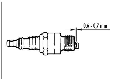
Mantener la bujía en buen estado permite reducir el consumo y mejorar el funcionamiento del motor.
