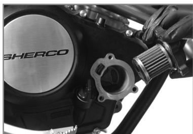
Für die Montage in umgekehrter Reihenfolge vorgehen und darauf achten, dass die O-Ringe des Ölfilterdeckels und der Ablassschraube sich in der richtigen Position befinden.
