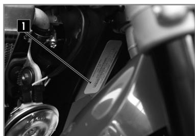
**1** Le numéro du châssis est gravé derrière le garde boue avant, sous la colonne de direction.
