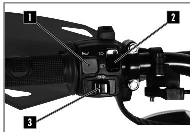
L'interrupteur des feux et des autres fonctionnalités est positionné sur le côté gauche du guidon et est ainsi constitué:
