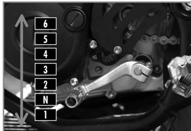
Le levier de vitesses est monté sur le côté gauche du moteur.
