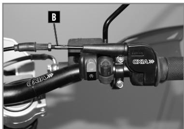
En caso de que el puño del acelerador tenga una carrera en vacío de más de 3 mm, medida en el borde del puño, habrá que ajustarlo con el regulador del cable **B**.
