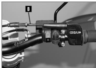
Dans le cas où la poignée de l'accélérateur présenterait une course à vide de plus de 3 mm, mesurée sur le bord de la poignée, il est nécessaire d'en effectuer le réglage en agissant sur tendeur de câble **B**.
