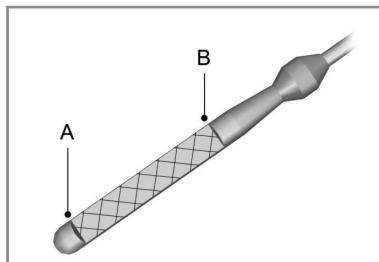
Der Ölstand muss sich zwischen den Markierungen MIN **A** und MAX **B** befinden.
