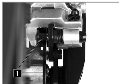
L'état d'usure des plaquettes de frein est visible en regardant l'extrémité des 2 plaquettes sur l'étrier **1** qui devront avoir au minimum une épaisseur de 2 mm de garniture.
