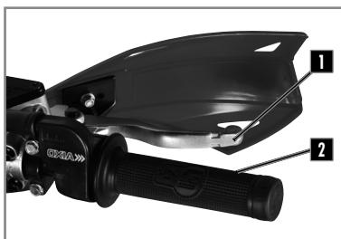
Der Vorderradbremshobel **1** und der Gashebel **2** sind an der rechten Seite des Lenkers montiert.
