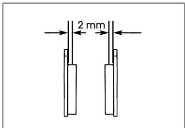
El estado de desgaste de las pastillas de freno se puede apreciar mirando el extremo de las 2 pastillas colocadas en la pinza (ver flecha) que deben tener un grosor mínimo de 2 mm.
