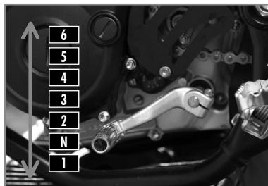
Der Fußschalthebel befindet sich an der linken Seite des Motors.
