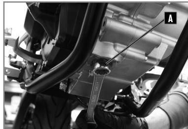
Esta operación debe realizarse con el motor caliente.
