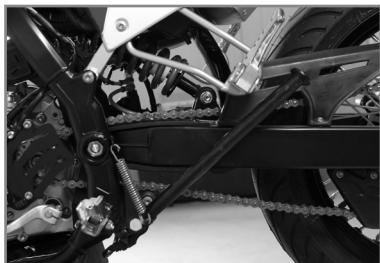
Den Ständer (linke Seite) bis zum Anschlag nach unten klappen und dann das Motorrad nach links neigen, bis der Ständer Bodenkontakt hat.
