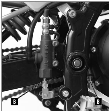
El freno trasero es un disco con control hidráulico. Se puede variar la posición de la palanca mediante el tornillo **B**.
