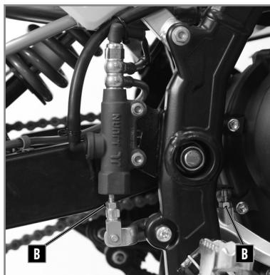
Bei der Hinterradbremse handelt es sich um eine hydraulisch betätigte Scheibenbremse.
