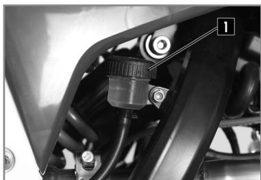
Der Ölstand darf nie unter den auf dem Gefäß angegebenen Mindeststand sinken.
