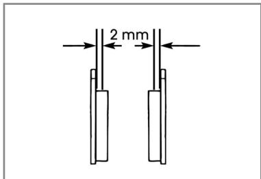
Der Abnutzungsgrad der Bremsbeläge ist am Rand der 2 Beläge am Bremskörper (siehe Pfeil) erkennbar. Die Beläge müssen mindestens einen 2 mm starken Belag aufweisen.
