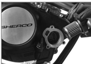
Proceda en orden inverso para el montaje, teniendo cuidado de que las juntas tóricas de la tapa del filtro de aceite y del tapón de vaciado estén en la posición correcta.
