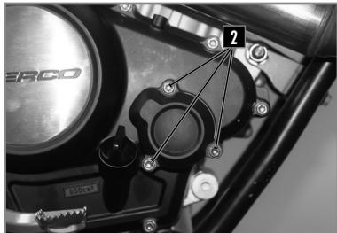
Déposer le couvercle du filtre à huile, situé sur le côté droit du moteur, après avoir retiré ses 3 vis **2**.
