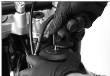
Zum Öffnen des Kraftstofftankdeckels den Schlüssel in das Schloss stecken und entgegen dem Uhrzeigersinn drehen. Tankdeckel anschließend in die gleiche Richtung drehen.
