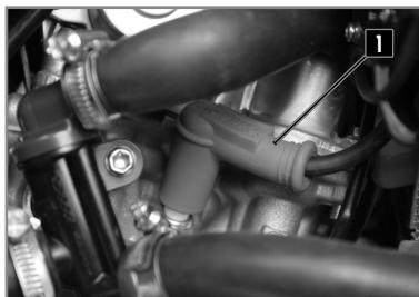
Sople la bujía con aire comprimido para evitar que los posibles residuos entren en el motor.
