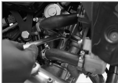
Engrase la rosca de la bujía y (con el motor frío), atorníllela con la mano al máximo y bloquéela con la llave.
