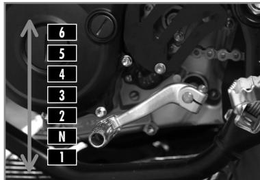
La palanca del cambio de velocidades se encuentra en el lado izquierdo del motor.
