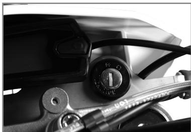
Das Fahrzeug ist mit zwei Schlüsseln ausgestattet (einer als Ersatzschlüssel), zur Betätigung des Schlüsselschalters, um den Motor anzulassen oder auszuschalten.
