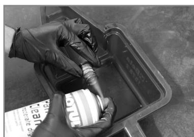
El filtro debe limpiarse con desengrasante y soplarse con aire comprimido.
