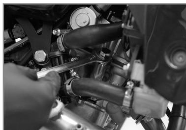
Lubrifier le filetage de la bougie et (moteur à froid), la visser à la main jusqu'à la butée puis la bloquer avec la clé.
