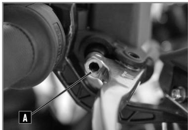
Le frein avant est à disque à commande hydraulique. Il est possible de faire varier la position du levier en intervenant sur la vis **A**.
