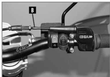
Wenn der Gasgriff einen Leerlaufhub von mehr als 3 mm, gemessen an der Kante des Gasgriffs, aufweist, muss er mit dem Seilzugversteller **B** eingestellt werden.
