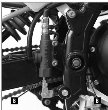
Le frein arrière est à disque à commande hydraulique. Il est possible de varier la position de la pédale en hauteur en intervenant sur les écrous **B**.
