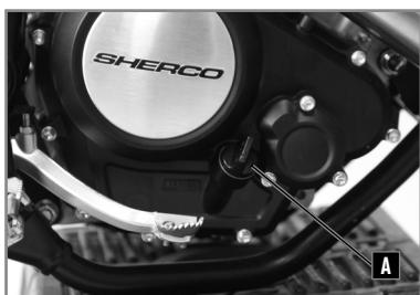
On contrôle le niveau de l'huile à l'aide de la jauge rattachée au bouchon de remplissage situé sur la droite de la moto **A**.
