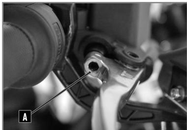
El freno delantero es un disco con control hidráulico. Se puede variar la posición de la palanca mediante el tornillo **A**.
