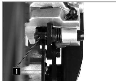
Der Abnutzungsgrad der Bremsbeläge ist am Rand der 2 Beläge am Bremskörper 1 erkennbar. Die Beläge müssen mindestens einen 2 mm starken Belag aufweisen.
