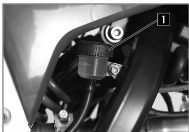
Le niveau de liquide ne doit jamais être inférieur au niveau minimum indiqué sur le bocal.
