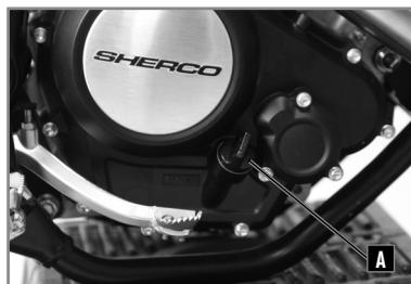
Der Ölstand wird mit dem Stab im Einfülldeckel **A** auf der rechten Seite des Motorrads geprüft.
