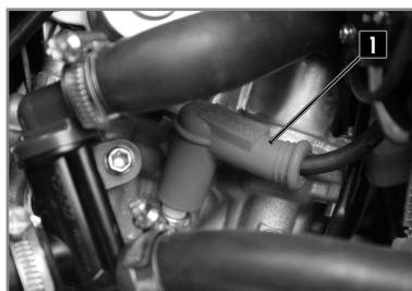
Vérifiez également que l'isolant ne soit pas craquelé et que l'électrode ne soit pas corrodée. Dans ce cas procédez immédiatement au remplacement de la bougie.
