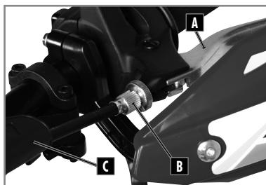
Das Einstellen des Hebels **A** am Register **B** vornehmen, nachdem Sie den Staubschutz aus Gummi **C** angehoben haben.
