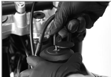
Pour ouvrir le bouchon de réservoir d'essence, insérer la clé dans sa serrure et la tourner dans le sens inverse des aiguilles d'une montre, puis tourner le bouchon dans le même sens.
