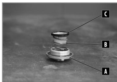
Entfernen Sie die Ablassschraube **A**, Feder **B** und
