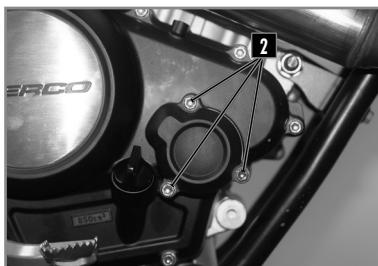
Retire la tapa del filtro de aceite, situada en el lado derecho del motor, después de haber retirado sus 3 tornillos **2**.
