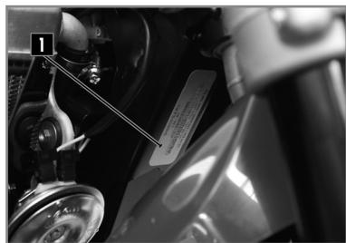
**1** Die Seriennummer des Fahrgestells ist auf der rechten Seite der Lenksäule eingeschlagen.
