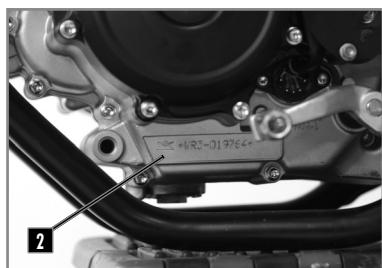
**2** Die Motornummer ist auf der linken Gehäusehälfte eingraviert.
