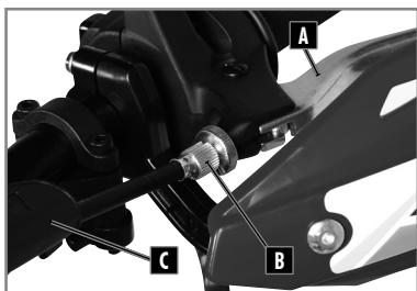
Para ajustar la palanca **A**, hay que actuar en el regulador **B**, tras levantar la cubierta antipolvo de goma **C**.
