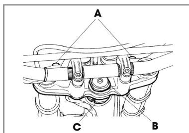
Controle periódicamente el juego de la columna de dirección moviendo de adelante atrás la horquilla. En caso de detectar cierto juego, ajuste de la siguiente manera:
