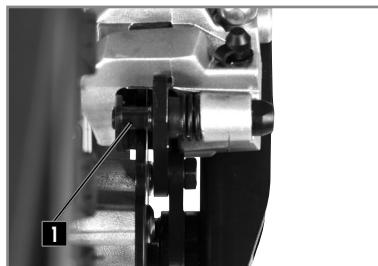
El estado de desgaste de las pastillas de freno se puede apreciar mirando el extremo de las 2 pastillas colocadas en la pinza (ver flecha) que deben tener un grosor mínimo de 2 mm. **1**
