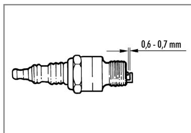
Wenn man die Zündkerze in einem optimalen Zustand hält, so trägt dies zur Senkung des Verbrauchs und zur optimalen Motorfunktion bei.
