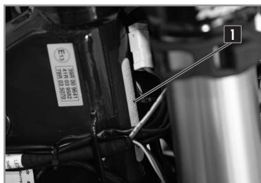
1 Die Seriennummer des Fahrzeugs ist auf der rechten Seite der Lenksäule eingeschlagen.
