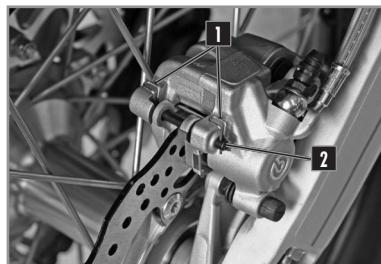
Sicherstellen, dass die Bremsscheiben nicht mit Öl oder Fett verschmutzt sind. Falls doch, die Scheiben mit Reinigungsmittel für Bremsen reinigen.
