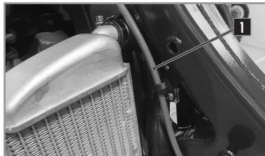
Asegúrese de que los cables y mangueras estén correctamente encaminados 1 .
