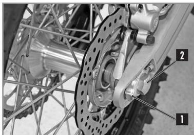
Die Kettenspanner **1** positionieren und die Mutter **2** anbringen, aber noch nicht festziehen.
