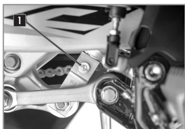
El tornillo de ajuste 1 determina el comportamiento del amortiguador en distensión. Girar el tornillo hacia la derecha aumenta el freno hidráulico (y viceversa).
