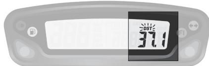
Fig 6 Fonction ajustement distance
