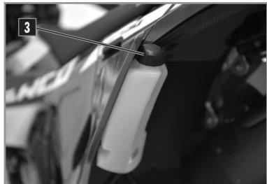
Comprobar el nivel de líquido en el depósito de expansión.
