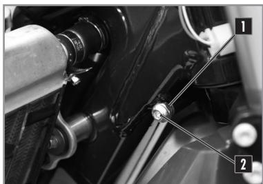
L'angle de braquage peut-être modifié en utilisant les vis de réglages situées sur les bords inférieurs de la colonne de direction.
