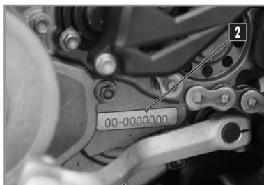
2 Die Motornummer ist auf der linken Seite des Gehäuses eingeschlagen.
