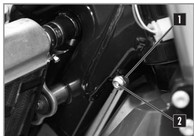
El ángulo de giro puede modificarse utilizando los tornillos de reglaje situados en los bordes inferiores de la columna de dirección.
