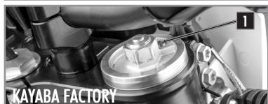
Después de algún tiempo de funcionamiento, el aire se acumula bajo presión en la horquilla.
