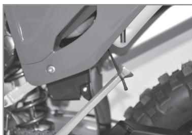
Das Sicherheitsgummi 1 entfernen, den Fuß auf den Ständer drücken und ihn ausgeklappt halten, bis er das ganze Gewicht des Motorrads trägt.
