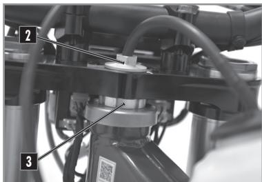
Contrôler le jeu des roulements de direction (p.40). Retirer la moto du trépied.
