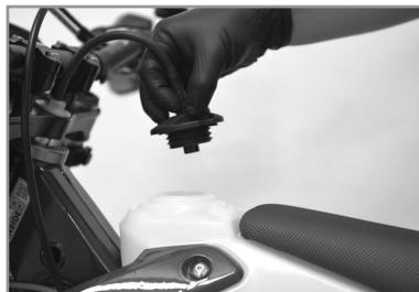
**Öffnen:** Den Tankverschluss gegen den Uhrzeigersinn drehen.
