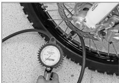
Contrôler régulièrement la pression des pneumatiques avec un manomètre de précision.
