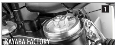
Après quelque temps de fonctionnement, l'air s'accumule sous pression dans la fourche.
