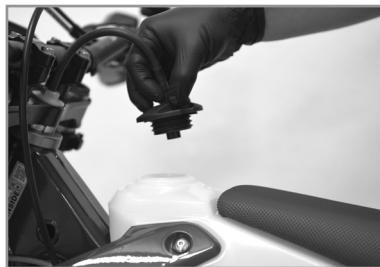
**Ouverture :** Tourner le bouchon dans le sens inverse des aiguilles d'une montre.
