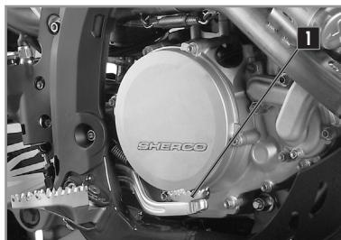
1 Bedienung der Hinterradbremse.
