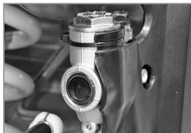
Das Motorrad auf eine ebene Fläche stellen. Den Flüssigkeitsstand an der Anzeige prüfen.
