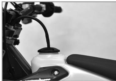
Utilice únicamente gasolina súper sin plomo con un índice de octanaje de al menos 95 mixto con aceite de 2 tiempos.
