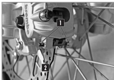
Neue Bremsbeläge anbringen Die beiden Achsen **2** und die Clips **1** wieder anbringen.
