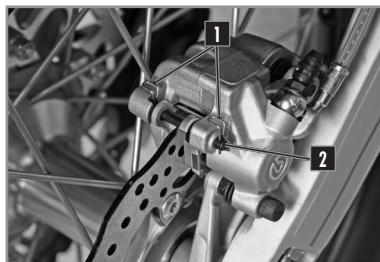
Vérifier que les disques de frein ne soient pas souillés d'huile ou de graisse. Dans ce cas, nettoyer les disques avec du nettoyant pour freins.
