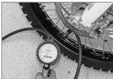
Regelmäßig mit einem Präzisionsmanometer den Druck in den Reifen prüfen.
