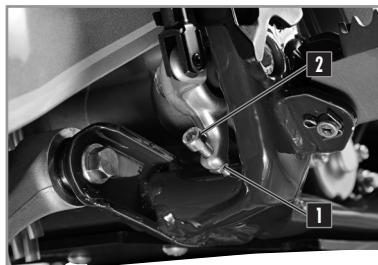
La posición del pedal de freno se regula del siguiente modo: desbloquear la contratuerca 1 después apretar o aflojar el tornillo 2 para encontrar la posición deseada. Apretar la tuerca una vez el pedal esté reglado.
