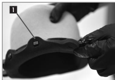
Das Filterelement wieder auf seiner Halterung anbringen. Darauf achten, dass es an den sechs Nasen **1** optimal angebracht ist.
