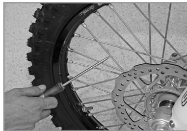
No olvidar el control y la tensión de los radios.
