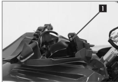
Le groupe optique avant est scellé à LEDs.
