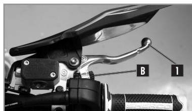
La maneta de freno delantero **1** está en el lado derecho del manillar y dispone de un tornillo de reglaje **B**.
