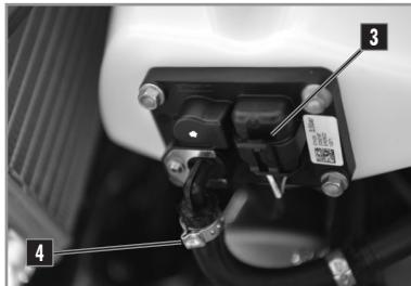
Vermeiden Sie, dass Schmutz in den Benzinschlauch gelangt. Dies kann zu einem Festfressen führen.
