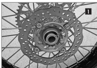
Sicherstellen, dass die Bremsscheiben nicht mit Öl oder Fett verschmutzt sind. Falls doch, die Scheiben mit einem Reinigungsmittel für Bremsen reinigen.
