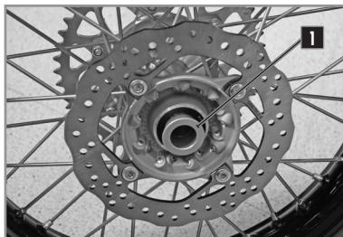
Vérifier que le disque de frein ne soit pas sale d'huile ou de graisse. Dans ce cas, nettoyer le disque avec du nettoyant pour freins.
