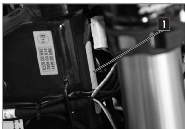
**1** Le numéro de série du véhicule est frappé sur le côté droit de la colonne de direction.
