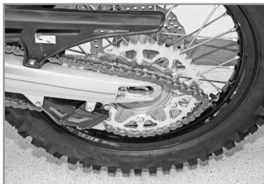
Das Rad im Schwingarm anbringen, die Achse zunächst einfetten und dann einführen.
