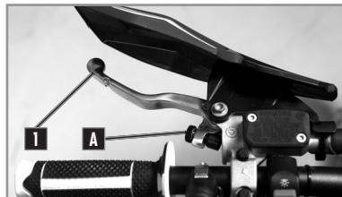
Le levier d'embrayage 1 est sur le côté gauche du guidon et dispose d'une vis de réglage A
