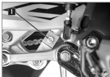
Die Einstellschraube 1 bestimmt das Verhalten des Stoßdämpfers während der Zugstufe.
