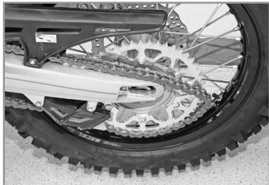
Installer la roue dans le bras et insérer l'axe de roue préalablement graissé.
