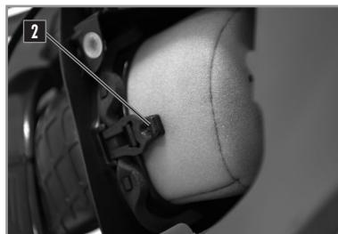
Den Filter mit seiner Halterung wieder anbringen, darauf achten, dass er optimal zentriert ist. Ersetzen Sie die Lasche **2**. Prüfen, ob der Luftfilter optimal platziert ist.
