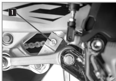
La vis de réglage 1 détermine le comportement de l'amortisseur en détente. Tourner la vis dans le sens des aiguilles d'une montre augmente le frein hydraulique (et vice-versa).
