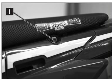
Lösen Sie die Befestigungsschraube **1** auf jeder Seite des Sattels.
