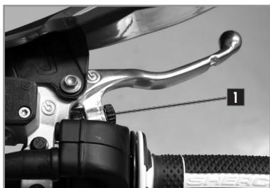
Régler la garde à l'aide de la vis de réglage **1**.
