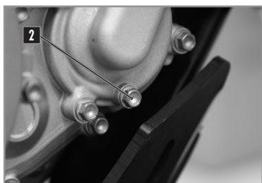
Schraube **2** mit einer neuen Dichtung wieder einsetzen.
