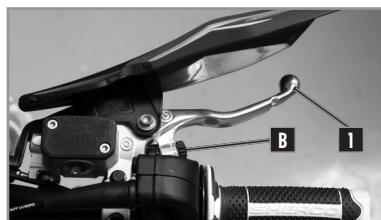
Le levier de frein avant 1 est sur le côté droit du guidon et dispose d'une vis de réglage B
