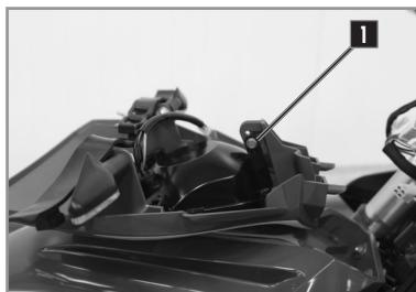
Die Reichweite wird an einem betriebsbereiten Motorrad mit darauf sitzendem Fahrer eingestellt. Zum Einstellen der Leuchtweite des Scheinwerfers die Schraube **1** lösen.
